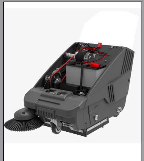
Robusta: Chásis metálico electrosoldado de 2 mm.
