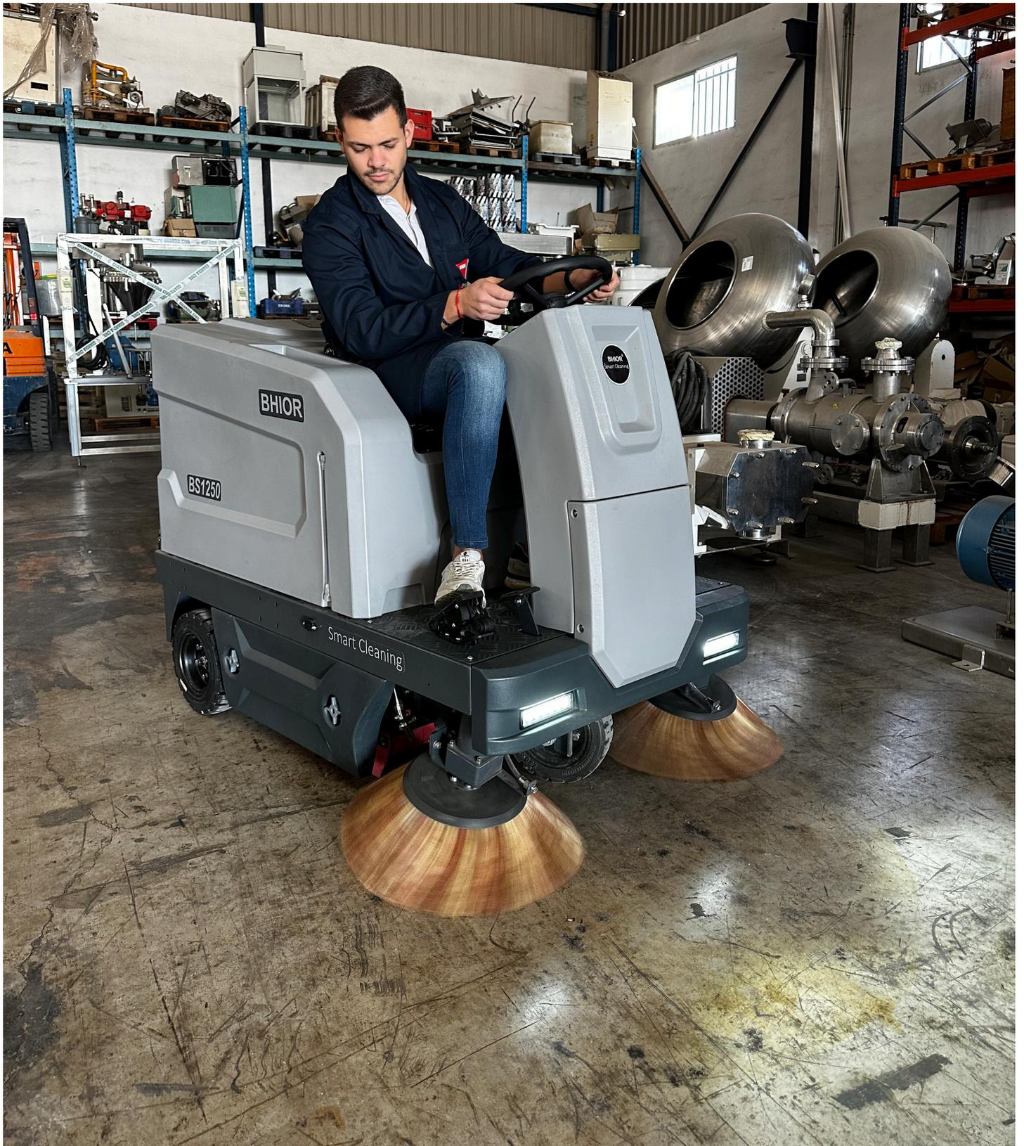
BHIOR BS1250 barredora-aspiradora con tracción trasera. Concebida para barrer la suciedad más resistente sobre superficies exteriores e interiores, de cualquier tipo de suelo.
