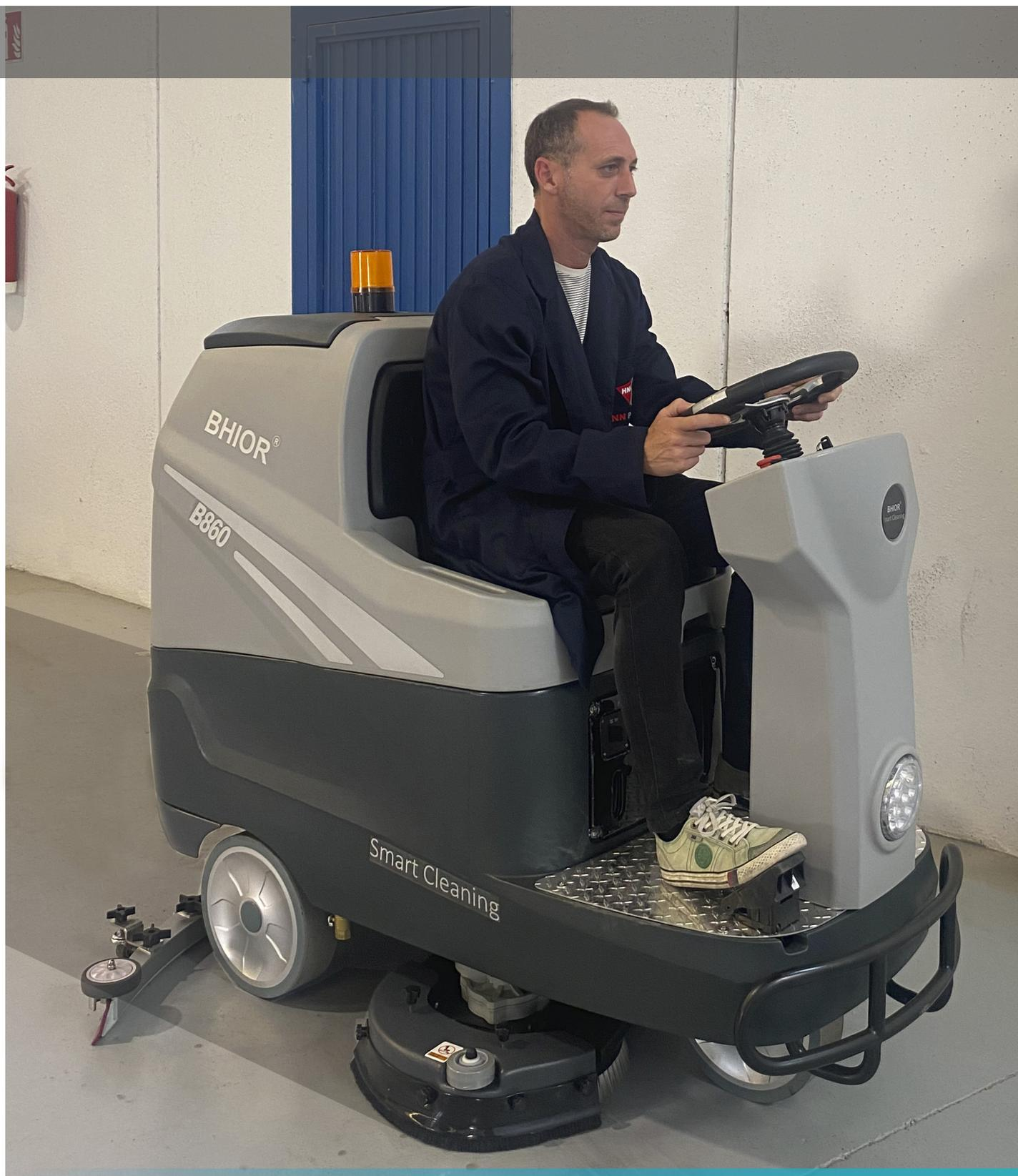
**BHIOR B860** fregadora-secadora con tracción trasera. Alto rendimiento con reducidas dimensiones, la solución ideal para la limpieza a fondo de grandes superficies.
