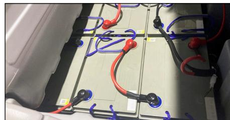
Baterías de 36V / 200 Ah sin mantenimiento, nos dan una autonomía de 6 horas (8 horas en modo ECO) . Posibilidad de batería de Litio
