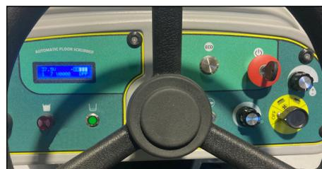
Completo panel de control: avisador de depósito de residuos lleno y de solución vacío, estado de batería, control de errores, regulación de agua, regulación velocidad, modo ECO, etc.
