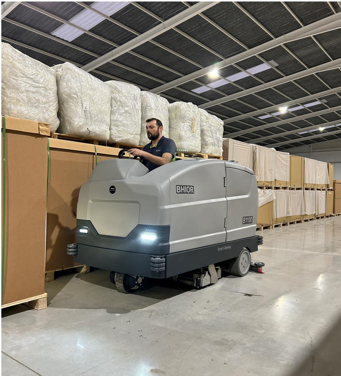
BHIOR B1100 Fregadora-secadora cilíndrica eléctrica. Una opción más de limpieza óptima y versátil para superficies de grandes dimensiones
